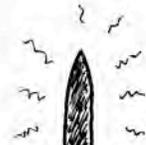
GLI OSSIDI SONO UN ISOLANTE PER IL CALORE, QUINDI BISOGNA PULIRE CON CURA LA PUNTA PRIMA DI FARE OGNI SALDATURA IN MODO CHE IL CALORE FLUISCA BENE IN QUESTO MODO FAREMO BUONE SALDATURE.
